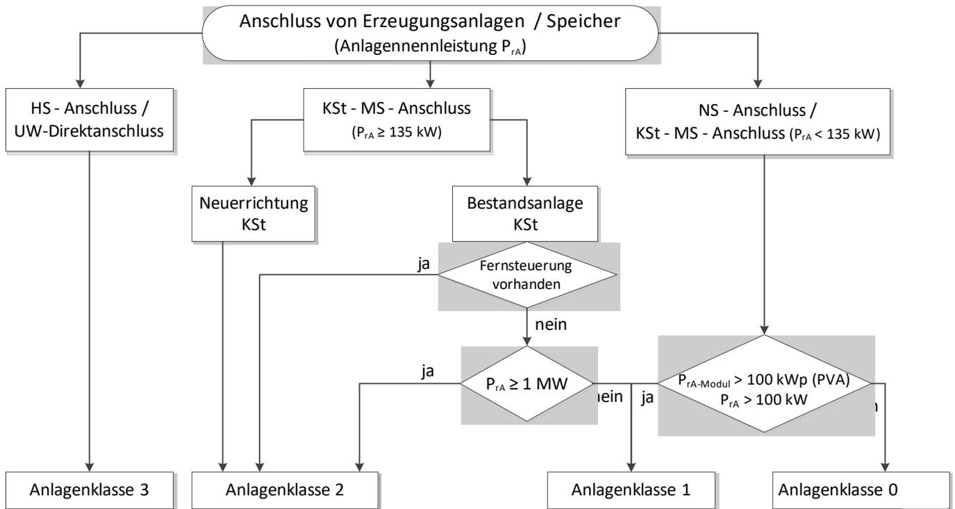
**Bild 1** Klassifizierung von EZA-Anlagen zur technischen Umsetzung des Wirk- und Blindleistungsmanagements
