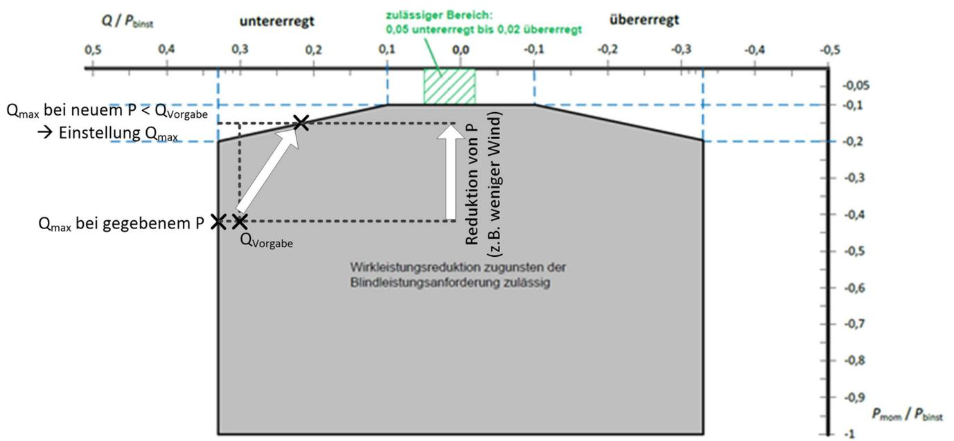
**Bild 2** Verhalten bei Überschreitung der Blindleistungsgrenze P durch Wirkleistungsreduzierung ( $P_{binst} = P_{rA}$ )
