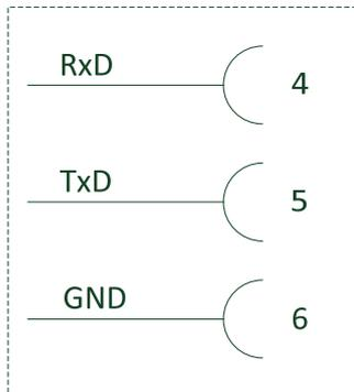
Bild 1 Signalbelegung RS232-Schnittstelle
